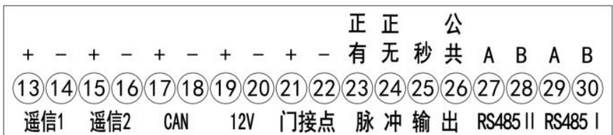
图 2 信号端子接线图
